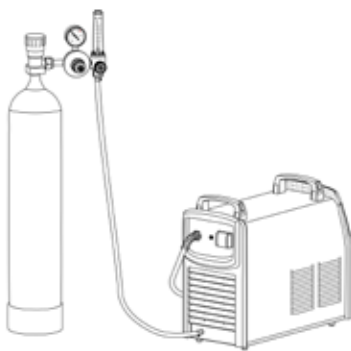
Рисунок 8.5. Подключение защитного газа.
