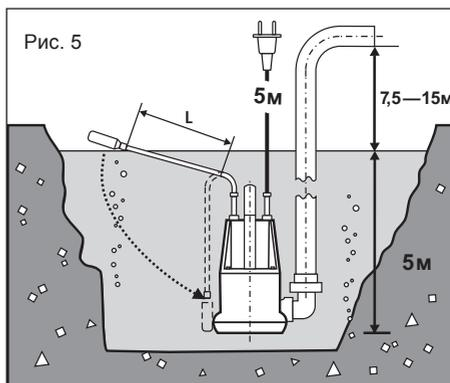
При установке определенного верхнего уровня (включения насоса) убедитесь, что в нижнем положении выключатель обеспечивает своевременное (до оголения водозаборных отверстий в нижней части) выключение насоса.
